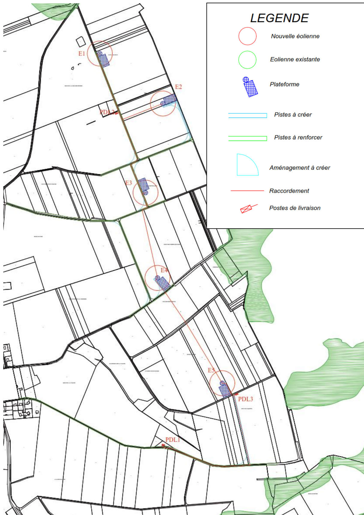
FIGURE 5 : PLAN D'IMPLANTATION DES EOLIENNES AVEC CHEMIN D'ACCES ET POSTES DE LIVRAISON
